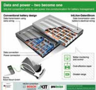
Цель проекта IntLiIon — разработка интеллектуальных технологий передачи данных специально для литий-ионных аккумуляторов, способных эффективно мониторить состояния и управлять каждой из сотни ячеек аккумулятора. Таким образом, исключаются затраты на дополнительную проводку, которая применяется во всех современных батареях.
